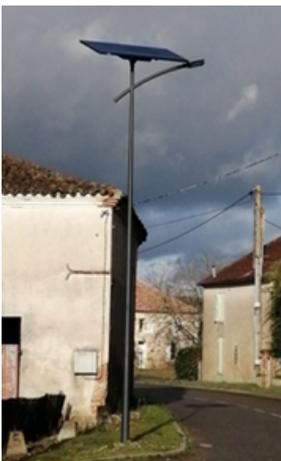
Les 2 lampadaires classiques de Causette ont été remplacés par 2 éclairages solaires. Cela permet de garder un éclairage tout en réduisant la consommation d'énergie électrique.
